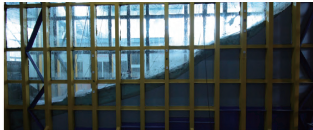
(c) 滑坡中后部发生滑动
