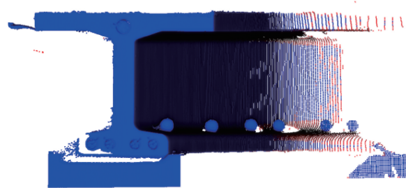
(b) 基于邻近点统计的噪声点检测方法
