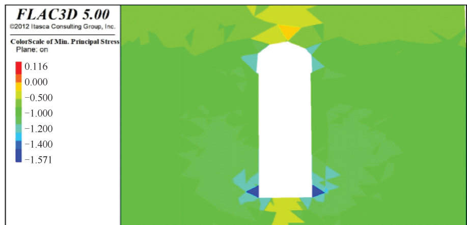
图 11 最大主应力分布云图(单位: MPa)
