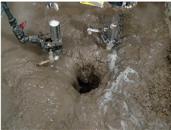
(c) 第二次试验初步塌陷
