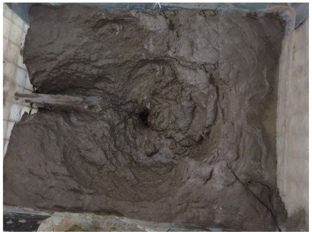
(b) 第一次试验最终塌陷
