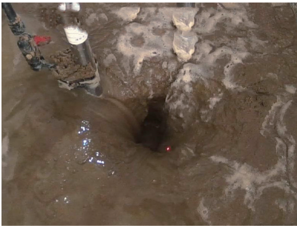
(a) 第一次试验初步塌陷
