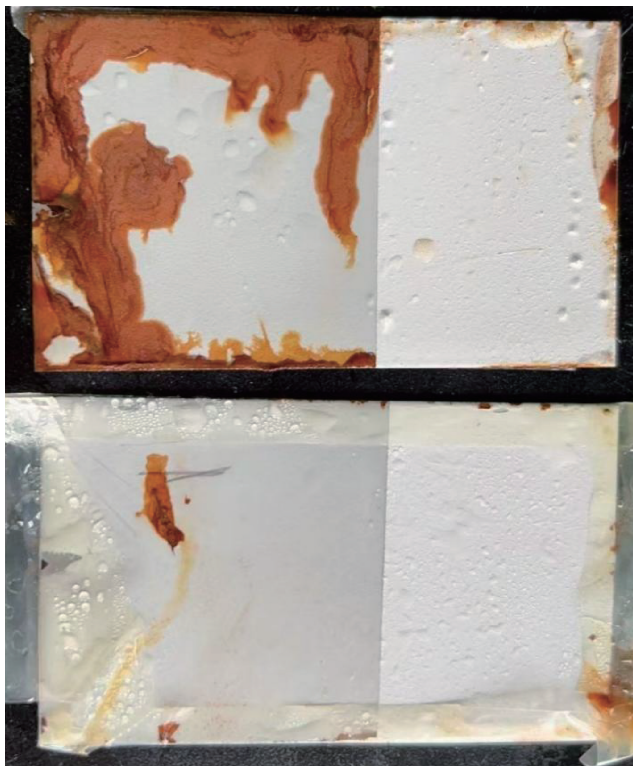
图5 涂层盐雾试验对比
