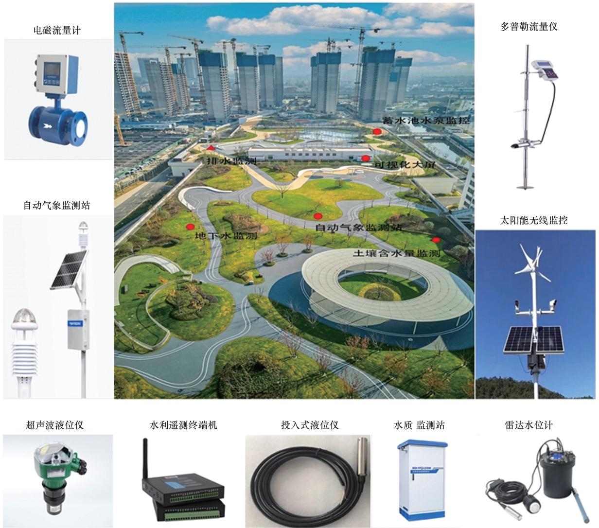
图 3 智慧海绵城市感知设备信息采集点
