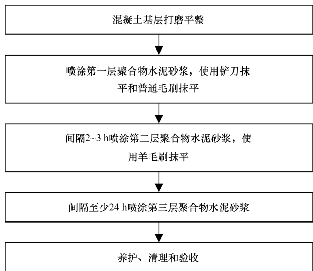
图 11 聚合物水泥砂浆施工流程
