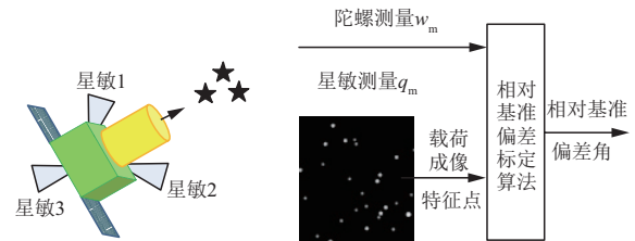
图9 相对基准自主标校示意图
