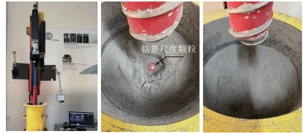
图10 临界尺度模拟月壤颗粒的钻进试验
