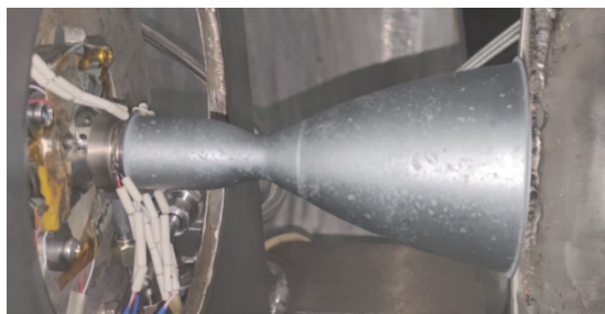
图2 真空舱中发动机安装状态
