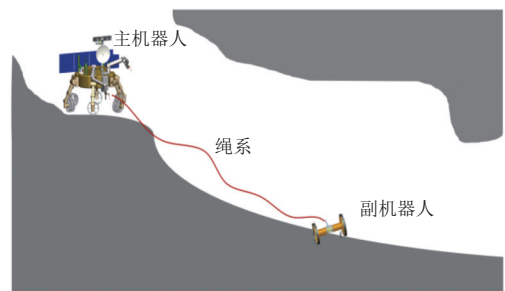
图9 主探测器与子探测器联合作业
