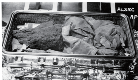
图1 月球样品返回封装箱 Fig. 1 Lunar sample sealed in container
