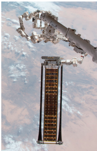
图2 卷绕式轻型太阳电池阵在轨测试 [23] Fig. 2 On-orbit flight testing of Roll-Out solar array [23]
