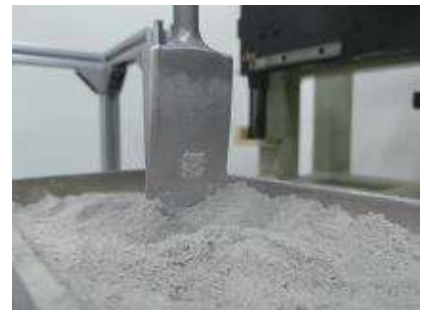
(a) 采样铲进行贯入采样
