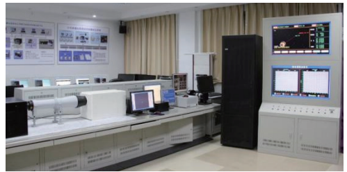
图6 小行星撞击自主导航与控制半物理仿真平台 Fig. 6 Semi-physical simulation platform for asteroid impact autonomous navigation and control
