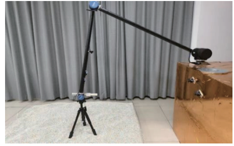
图 5 表取采样机械臂末端变形实验 Fig. 5 Robotic arm end deformation experiment
