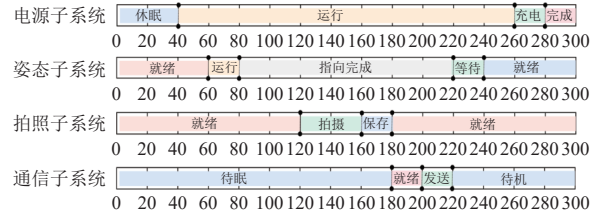
图 9 各子系统的任务甘特图 Fig. 9 Task Gantt chart of each subsystem
