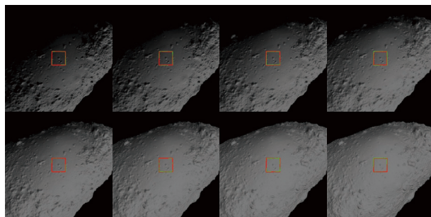
图 17 在不同相位角下，WNCC的部分匹配结果 Fig. 17 Part of the landmark matching results of WNCC under different phase angles
