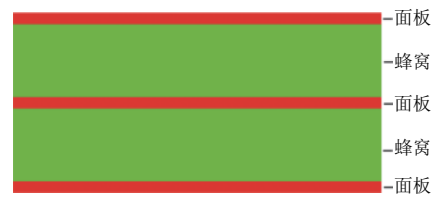
图11 多层蜂窝夹层结构示意图
