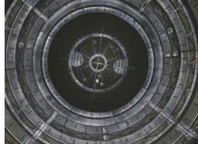
图15 全尺寸低温晃动试验
