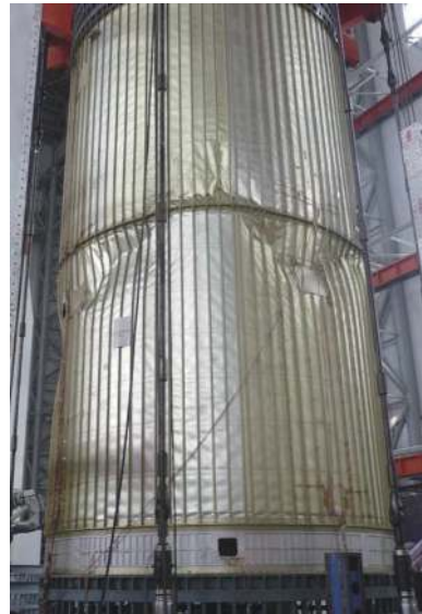
图18 均匀蒙皮桁条结构破坏试验
