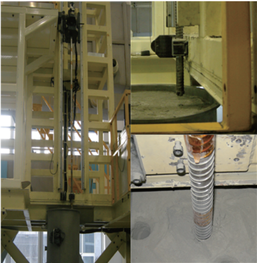
图 19 月壤钻进实验过程 Fig. 19 drilling process of lunar soil
