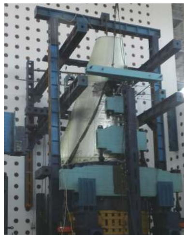
图4 轴压静力试验
