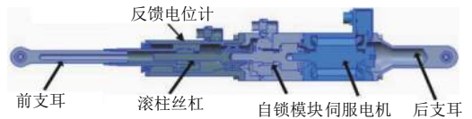
图 5 机电作动器三维图 Fig. 5 EMA
