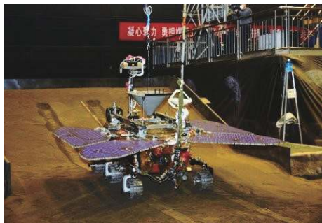
图 11 火星车机构控制系统自主任务试验
